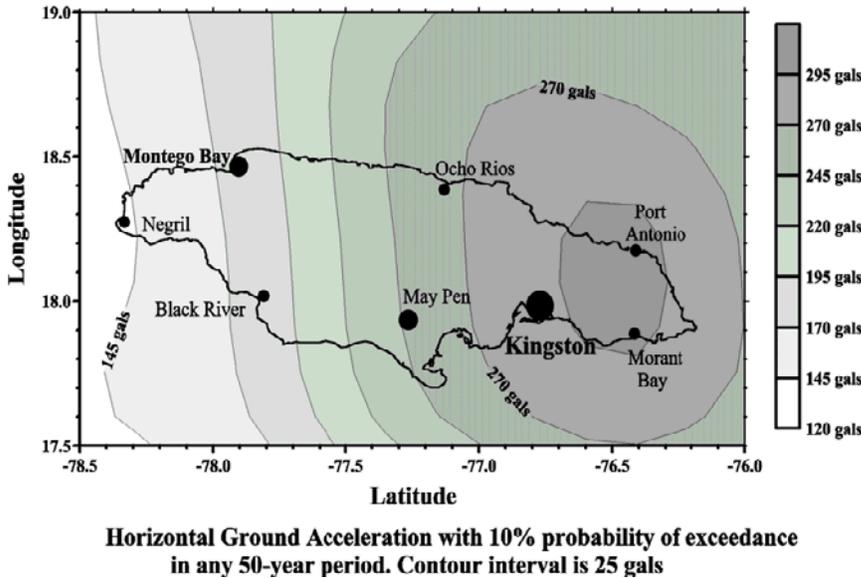
**FIGURE 3-10: HORIZONTAL GROUND ACCELERATION IN JAMAICA<sup>4</sup>**
