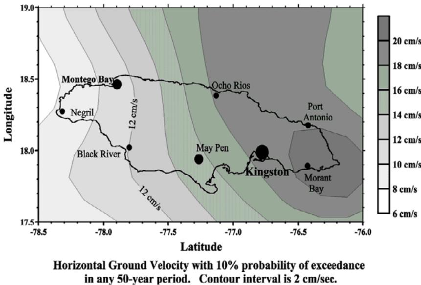
**FIGURE 3-12: HORIZONTAL GROUND VELOCITY IN JAMAICA<sup>6</sup>**
